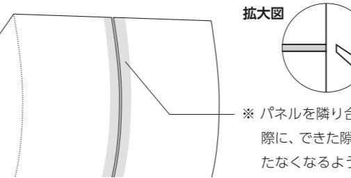
※ パネルを隣り合わせで設置する際に、できた隙間(目地)が目立たなくなるようにパテ処理又は寒冷紗+パテ処理を行い、パテ乾燥後にペーパーをあててから塗装を行ってください。
