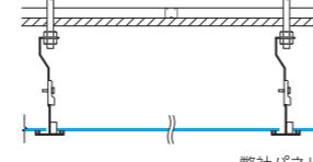
天井から吊り下げた金物フレームに乗せる形の設置方法となります。
