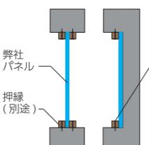
パネルを挟む押縁を設置し、ビスで固定させる方法になります。
