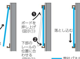
多めのクリアランスを設けた金物レール(または溝)に差し込み、設置する方法です。
